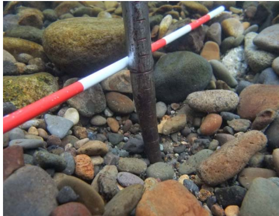
図3-1 卵の埋没深の測定方法
